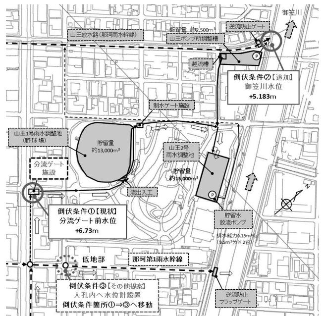
図21 分流ゲートの倒伏条件
